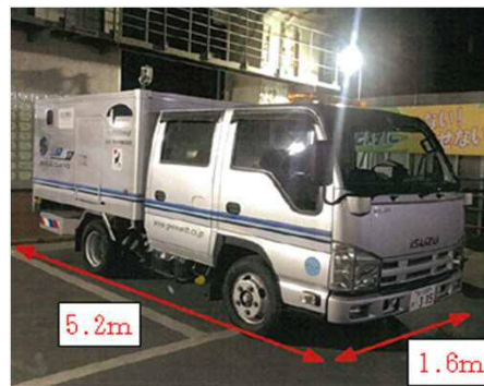
路面下空洞探査（車載型レーダー）
