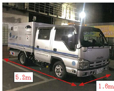
路面下空洞探査（車載型レーダー）
