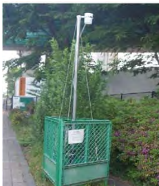
大気質(粉じん等)測定状況
