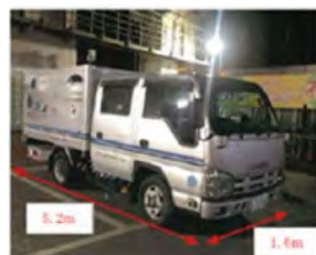
路面下空洞探査車
