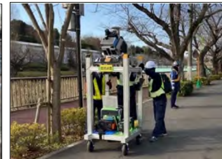
手押しスキャナ計測状況
