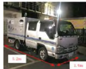
路面下空洞探査車
