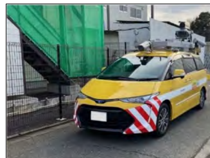
3D点群データ調査状況
