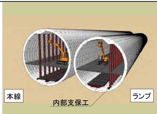
STEP2:内部支保工組立・坑内仮設備工
