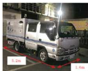
路面下空洞探査車
