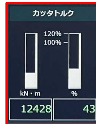
カッタートルクのリアルタイム監視状況の例
