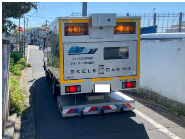
路面下空洞調査(車道部)
