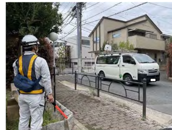
MMS[3D点群調査](車道部)
