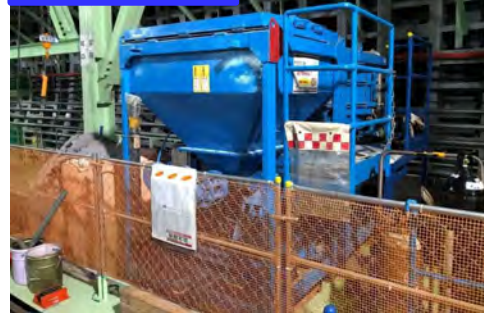
滑剤充填設備(大泉本線(北行)シールドトンネル工事の実績)
