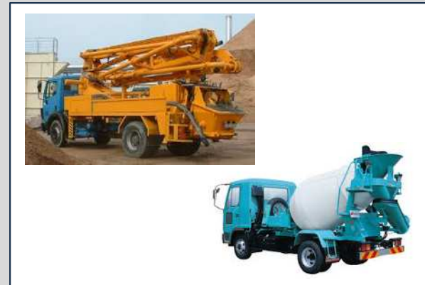
コンクリート打設をする機械
