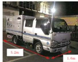
路面下空洞探査車
