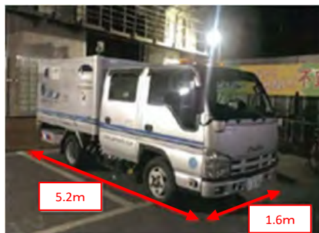
路面下空洞探査車(車載式レーダー)
