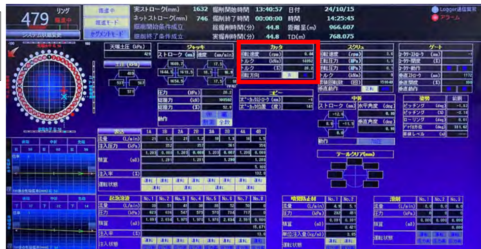
監視モニターによるリアルタイム監視
