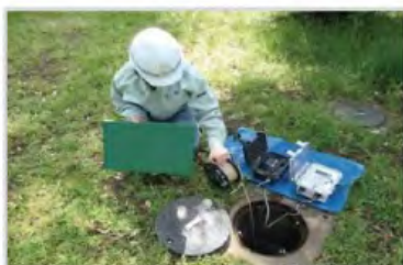
地下水位の観測状況
