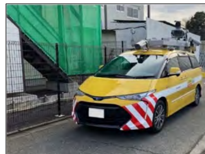
3D点群データ調査状況
