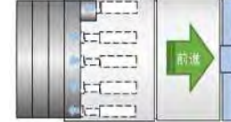
ジャッキ伸長途中でセグメントを組立 ジャッキ長さの調整による掘進
