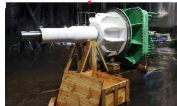
更新予定のモーター駆動軸部 写真
