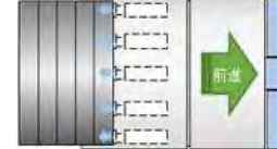
ジャッキ伸長途中でセグメントを組立 ジャッキ長さの調整による掘進
