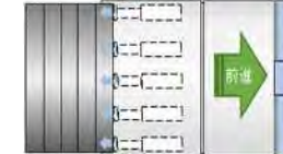
全ジャッキ伸長後にセグメントを組立
