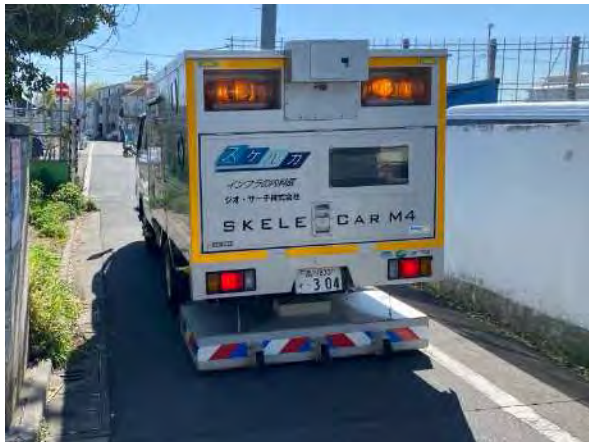
路面下空洞調査(車道部)
