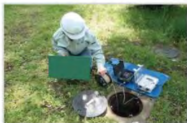
地下水位の観測状況
